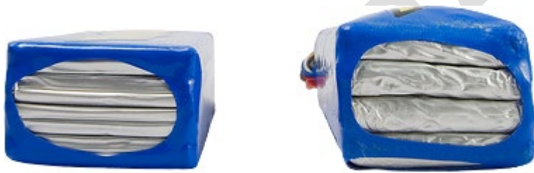
Nuevo paquete Li-Po (izquierda), paquete Li-Po inflado (derecha). Fuente: http://learningrc.com/
