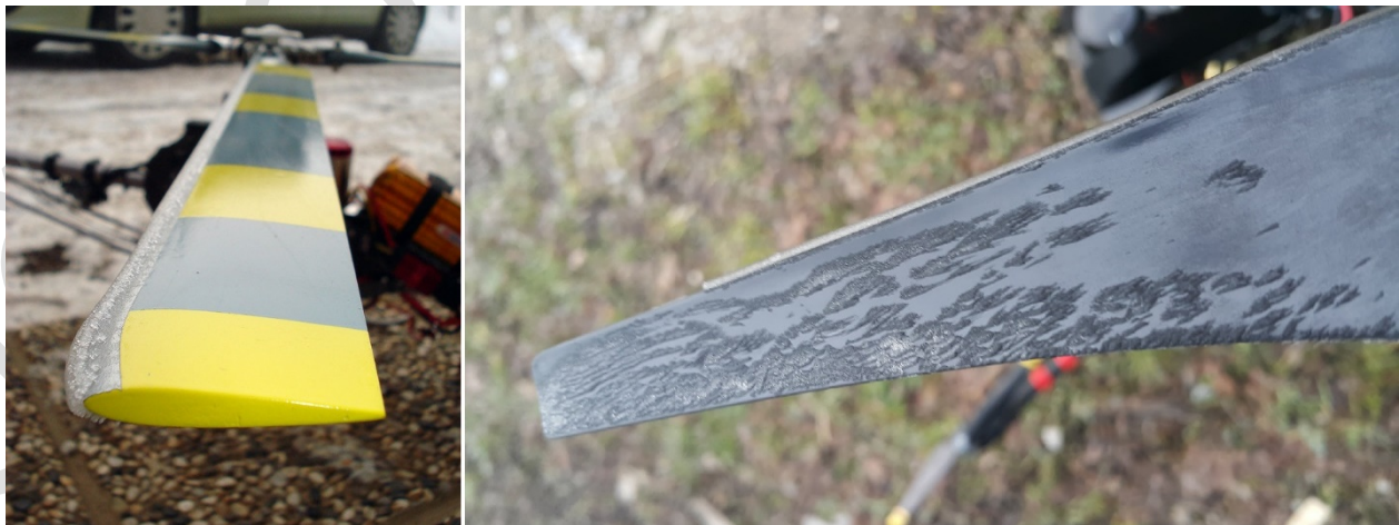
Ejemplos de formación de hielo en el brazo del helicóptero (izquierda) y en el brazo de la hélice multicóptero (derecha)
